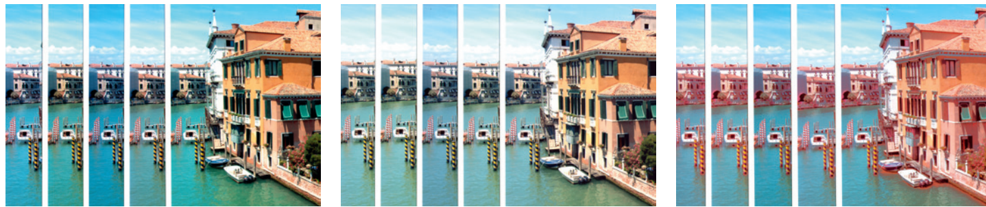
Op papier van achtereenvolgens Canon, Epson, HP, Arca en 123inkt.nl geven Canon-inkt en 123inkt.nl-huismerkinkt in de Canon Pixma Pro9000 Mark II even goede resultaten, maar met Arca One-inkt treedt een kleurverschuiving op. De voorgangers en volgende prints zijn netjes.
